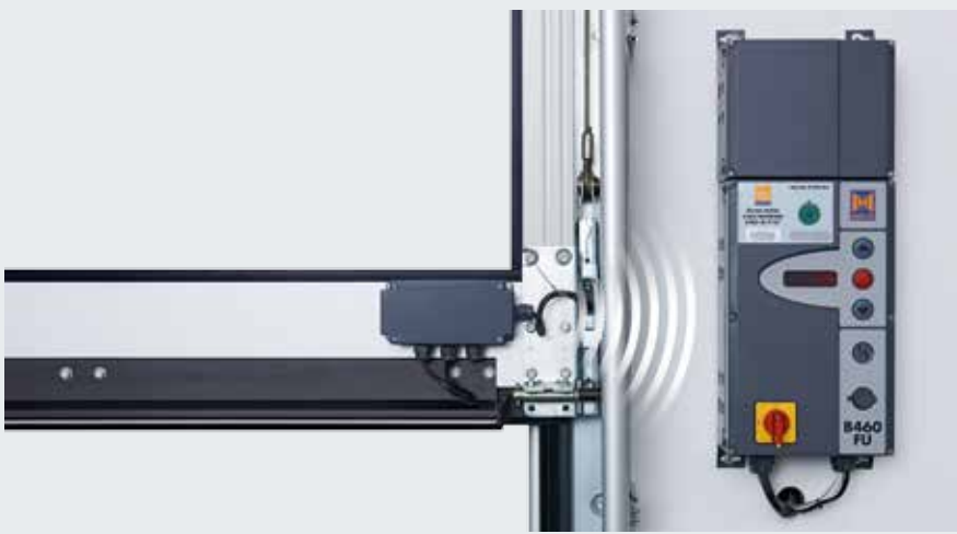
Unité de transmission sans fil Équipement optionnel pour la transmission des signaux du tablier de porte à la commande via Bluetooth – au lieu d'un câble spiralé. L'alimentation électrique est fournie par une pile puissante. Composants raccordables : optopalpeurs LE (basse consommation), cellule photoélectrique embarquée VL 1/2-LE, listel 8K2, contacteur mou de câble, contact de portillon incorporé, contact sur verrou de nuit
